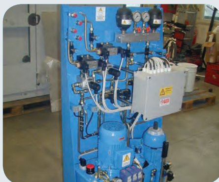
Centrale controllo freni di sicurezza.
