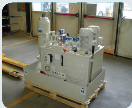
Centrale alimentazione comando di una paratoia.
