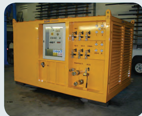
Gruppo oleodinamico da 450 kw per applicazioni da cantiere.
