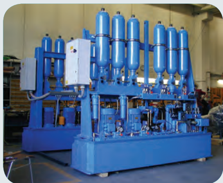
Centrale con accumulo per manovre in emergenza.
